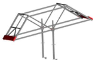
Schema van de borstwing voor inontvangstneming van materialen. Rust op twee speciale staanders.
